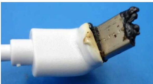
導電性の異物の付着により焼損したコネクタ
