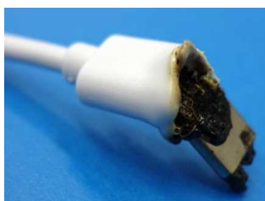
導電性の異物の付着により焼損したコネクタ
