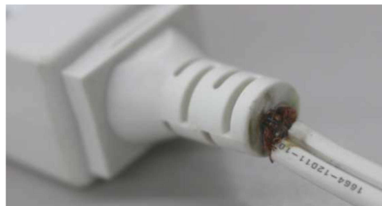
コードプロテクター先端部が断線している様子
